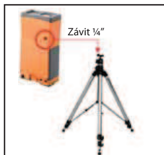
Měření z pevného bodu na stativu
